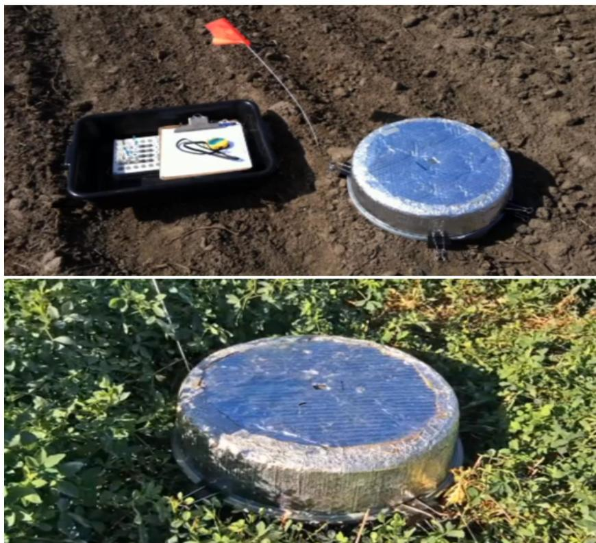
Figura 4 – Exemplo da câmara estática utilizada para a coleta das concentrações dos gases (COLLIER, et al, 2014).
